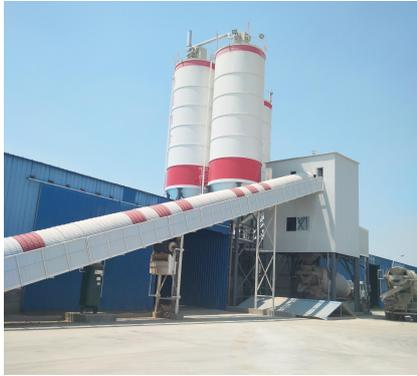
混凝土生产线
