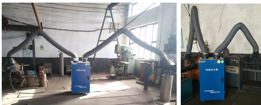
图4-1移动式焊接烟尘净化器
